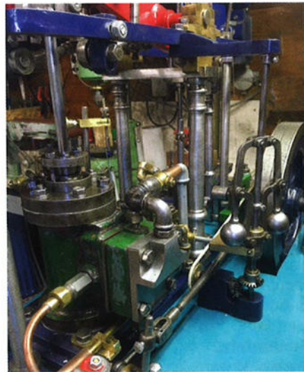
De andere zijde van de machine met fraaie details zoals de reguleur.
